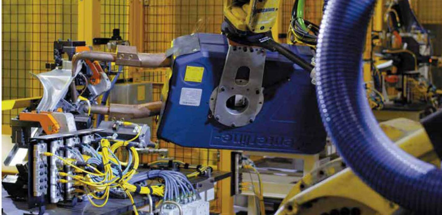
森德莱(CenterLine)定制的机器人焊接技术系统,配有多个机器人焊接站和伺服驱动FlexGun焊枪套装。
